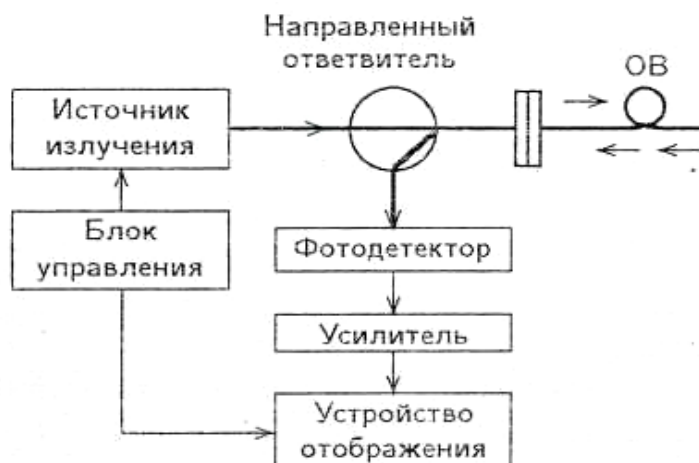
Рис. 4. Упрощенная структурная схема и принцип действия оптического рефлектометра
