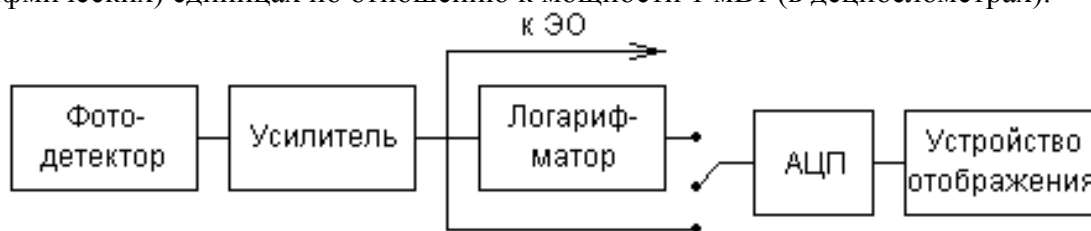
Рис. 1. Схема измерителя оптической мощности
