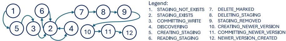
Рис. 3.7: Состояния исключительной блокировки: круг – состояние, стрелка – разрешенных переход
