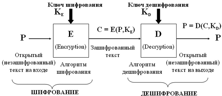
Рис. 9.4. Симметричная криптосистема
