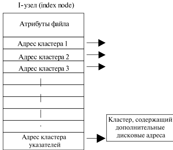
Рис. 7.18. Вариант физической организации файлов
