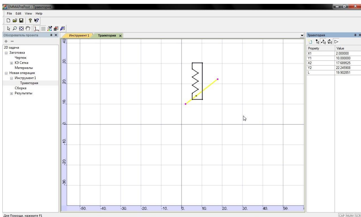
Рис.10. Перемещения инструмента в реальном времени. Справа показаны инструменты для создания траектории.
