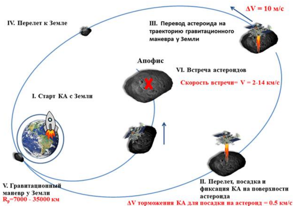
Рисунок 11. Схема наведения астероида-снаряда на опасный объект
