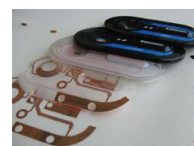
От сенсорной пленки к сэндвичевому компоненту из сенсорной и черной декоративной пленки.
