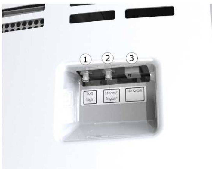
Рис. 4. Разъемы на задней панели тележки Nexstim
