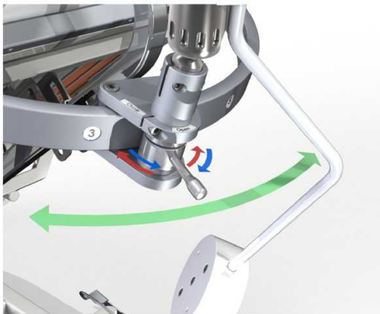
Рис. 37. Открытие фиксирующего рычага для перемещения держателя индуктора
